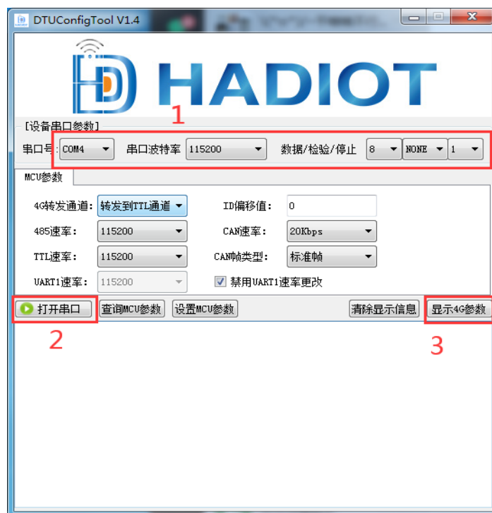
图4 设置软件设置步骤示意图 1
