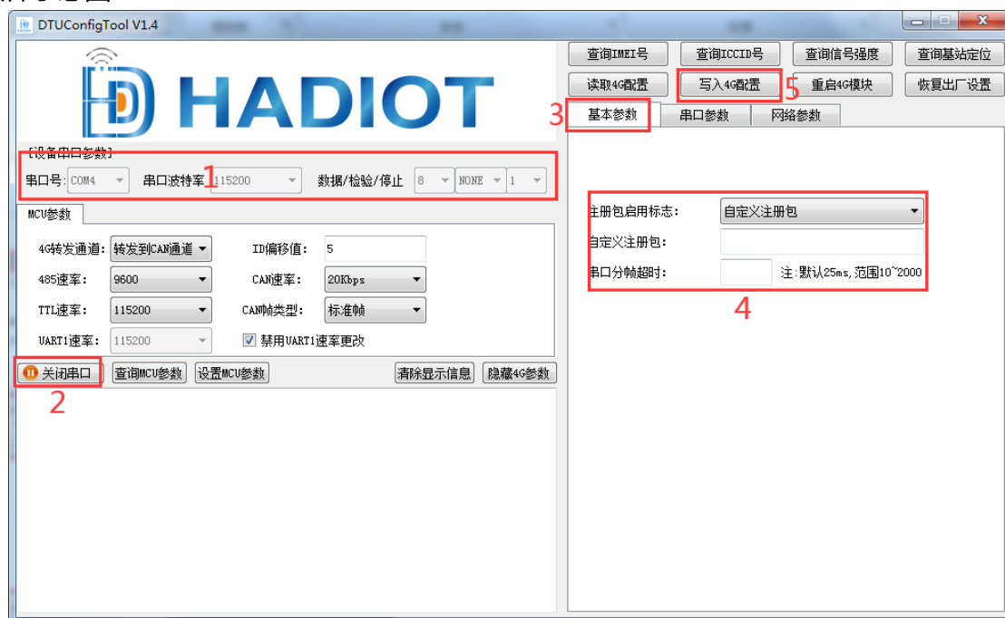
图 10 注册包软件设置步骤示意图
